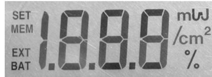
**Hinweis:** Wenn ein Lichtleiteradapter im optischen Anschluss installiert wurde, zeigt die Anzeige den Durchmesser des Lichtleiteradapters 3 Sekunden lang blinkend an.
