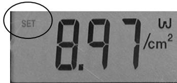
Wenn die Tastatur losgelassen wird, erleuchten auf der Anzeige eine Reihe von Strichen „---“, die angeben, dass der Sollwert zum OmniCure UV-Härtungssystem übermittelt wird und die Kalibrierung ausgeführt wird. Sobald die Striche nicht mehr angezeigt werden, ist der Kalibrierungsablauf abgeschlossen.
