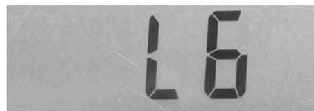
Wenn der Lichtleiter ganz eingesteckt ist, verlöscht die Anzeige. Wenn die Anzeige erleuchtet bleibt nachdem der Lichtleiter eingesteckt wurde, versuchen Sie ihn zu entfernen und wieder einzustecken.
