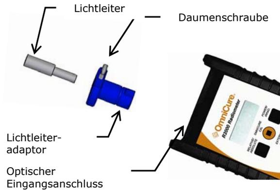
Wenn der Lichtleiteradapter richtig befestigt ist, kann er am Lichtleiter verbleiben, wenn der Lichtleiter entfernt wird.
