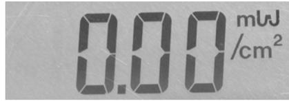
Falls die Anzeige nicht „  $/\text{cm}^2$  “ anzeigt, bedeutet dies, dass sich das R2000-Radiometer im Stromstärke-Modus befindet. Drücken Sie die POWER/IRRAD Taste, um in den Bestrahlungsstärken-Modus zu wechseln.
