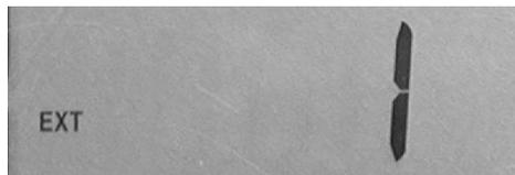
Falls mehrere Geräte angeschlossen werden, wird jedes Drücken der Taste EXTERNAL zur Erhöhung zum nächsten externen Gerät führen, bevor zum internen Modus zurückgekehrt wird. Dies wird dann angezeigt, wenn das EXT-Symbol nicht mehr erleuchtet ist.
