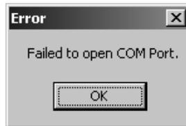
Wählen Sie COM Ports im „File“ Pulldown-Menü. Stellen Sie sicher, dass der betreffende COM-Port angekreuzt ist und das Kabel richtig angeschlossen ist. Versuchen Sie erneut zu verbinden.
