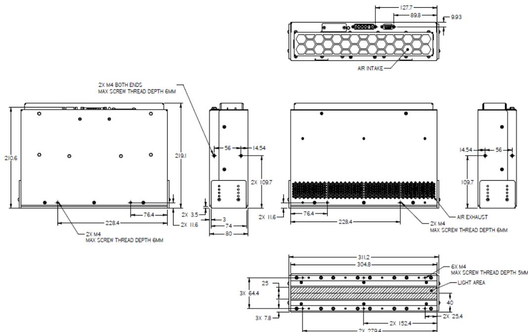
Figure 4 Dessins mécaniques des têtes LED UV du modèle AC8300
