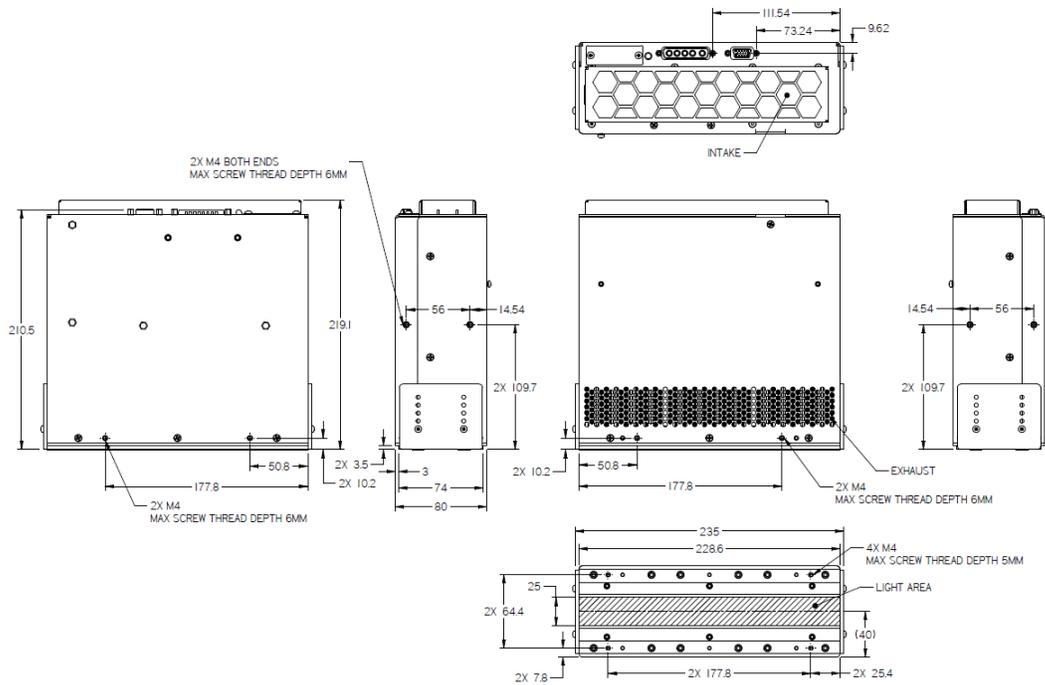
Figure 5 Dessins mécaniques des têtes LED UV du modèle AC8225
