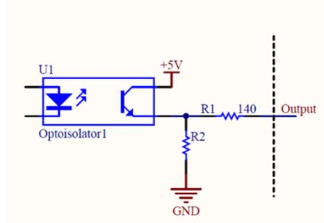
**Figure 8 - Circuit équivalent des sorties numériques PLC**
