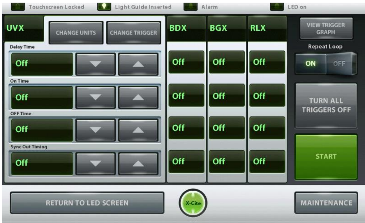
Figure 23 Écran déclencheurs LED (contrôleur à écran tactile)
