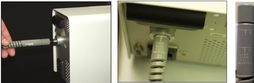
Figure 9 Insertion du guide de lumière
