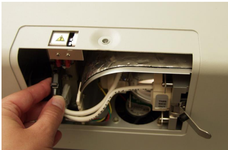
Figure 7 Connexion d'alimentation de la lampe
