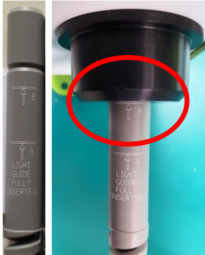
Figure 5 Position correcte pour le LLG X-Cite entièrement inséré, et le LLG avec lignes d'insertion A et B
