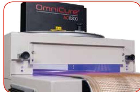
Intégration du convoyeur au système de polymérisation DEL UV de la gamme AC
